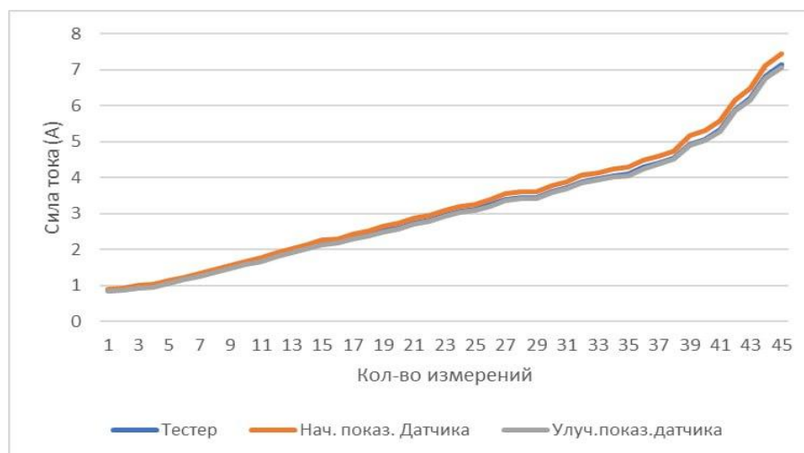
Рис.2. Сравнение начальных и улучшенных показателей датчика тока ACS712
