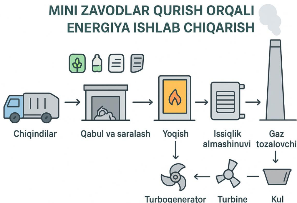
1-rasm. Mini chiqindi yoqish zavodining umumiy sxemasi.
