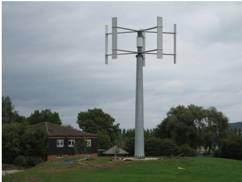
27-rasm. VAWT - Vertikal o'qli shamol turbinalari. Savonius - VAWT ning yana bir turi
