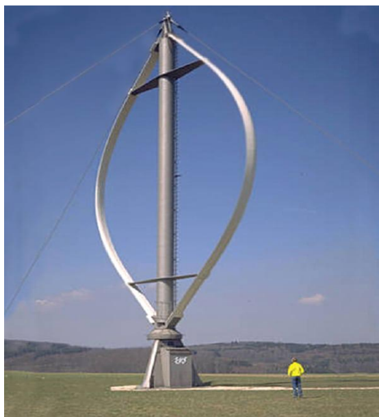
13-rasm. Darrieus. Frantsuz muhandisi Jorj Darrieusning 1931 yilda ishlab chiqarilgan vertikal o'qli shamol turbinasi dizayni - tuxum qoqib yuboruvchiga o'xshash - zamonaviy davrda qayta paydo bo'ldi.
