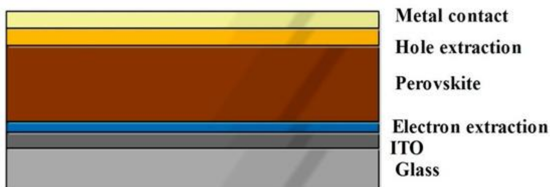
13-rasm. Sxematik diagramma oddiy Perovskit Arxitekturasini ifodalaydi.
