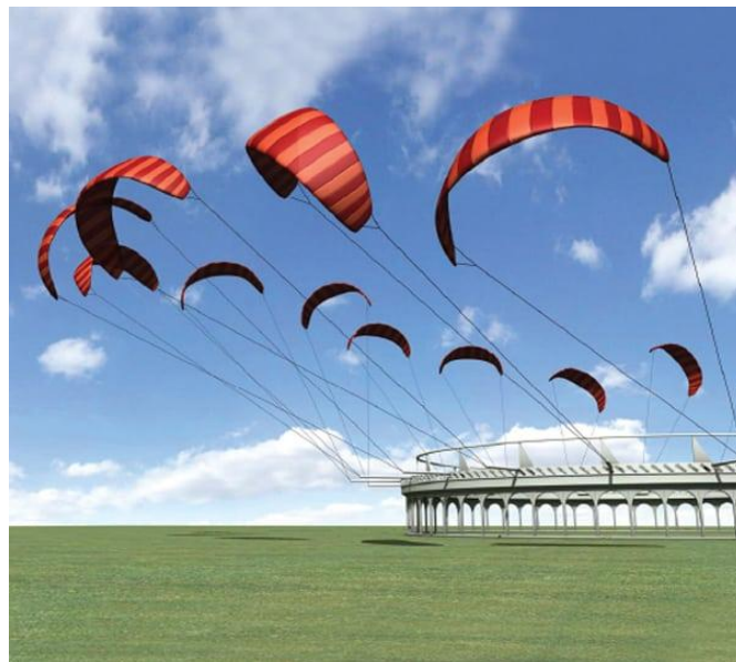
20-rasm. KiteGen. Italiyaning KiteGen kompaniyasining “karusel” yoki “poya” konfiguratsiyasida joylashgan elektr uchargichlari elektr stansiyasiga ulanadi va oldindan belgilangan parvoz yo'li bo'ylab uchadi.
