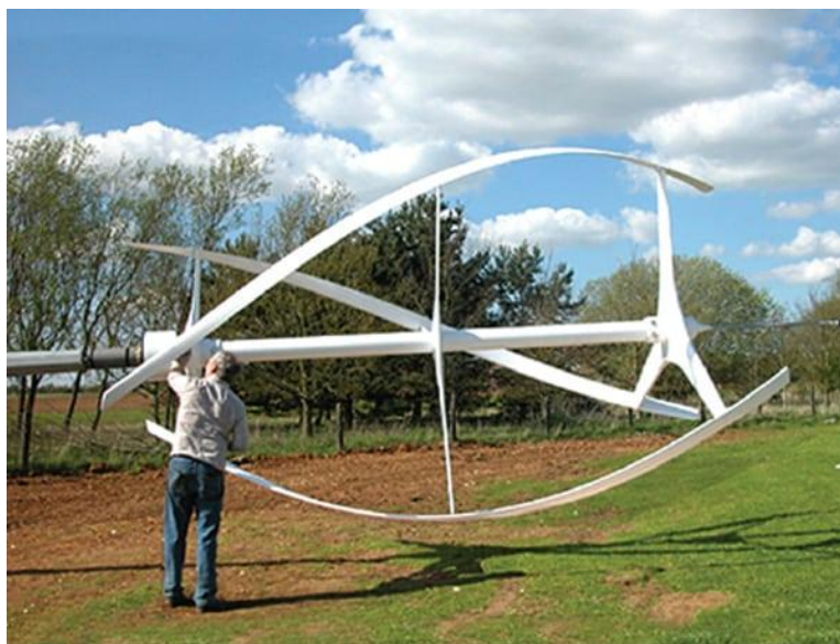
19-rasm. Sokin inqilob. Londonda joylashgan sessiz revolutionning qr5 VAWT shovqin va tebranishlarni bartaraf etish uchun mo'ljallangan.
