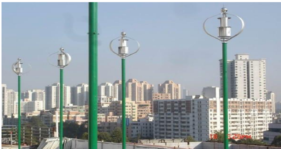
16-rasm Maglev. Xitoylik ishlab chiquvchilar 2006 yilgi Shamol quvvati Osiyo ko'rgazmasida magnit levitatsiyali shamol turbinasini namoyish qilganlarida, bu shamol texnologiyasi evolyutsiyasidagi yutuq sifatida e'tirof etildi. Texnologiya
