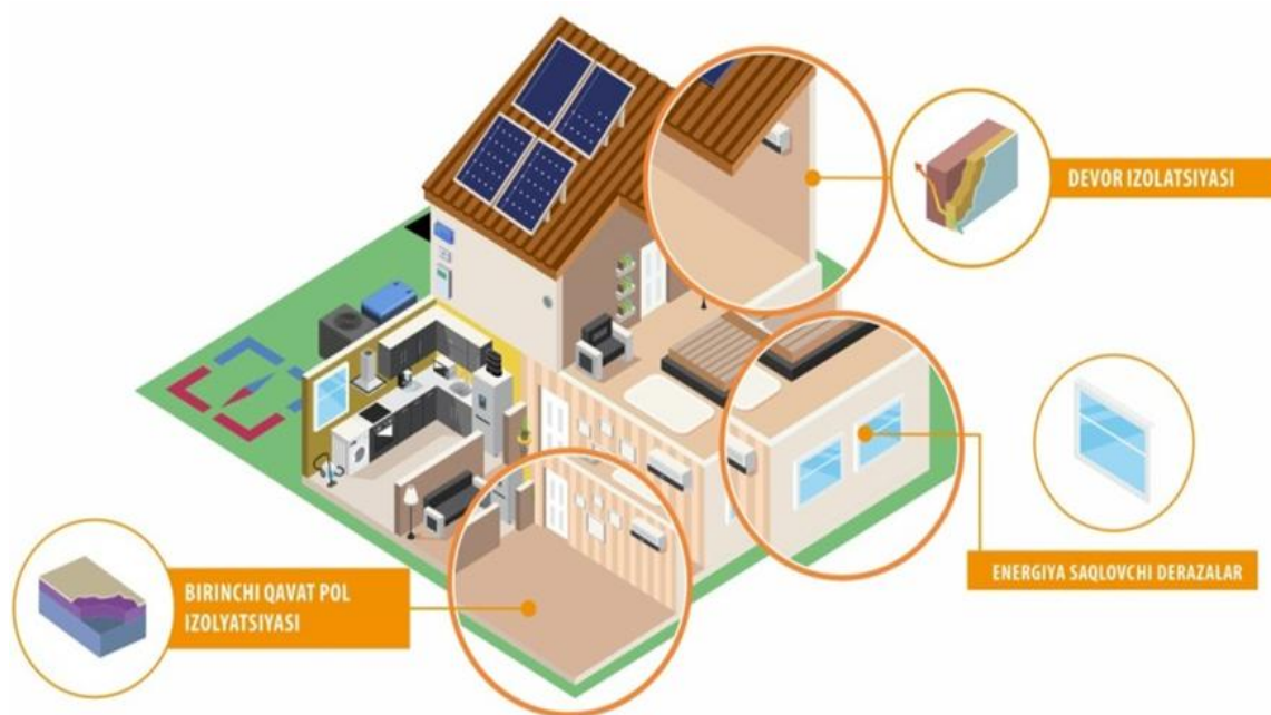
3.14-rasm. Energiya saqlovchi uyning izolyatsiya materiallar.
