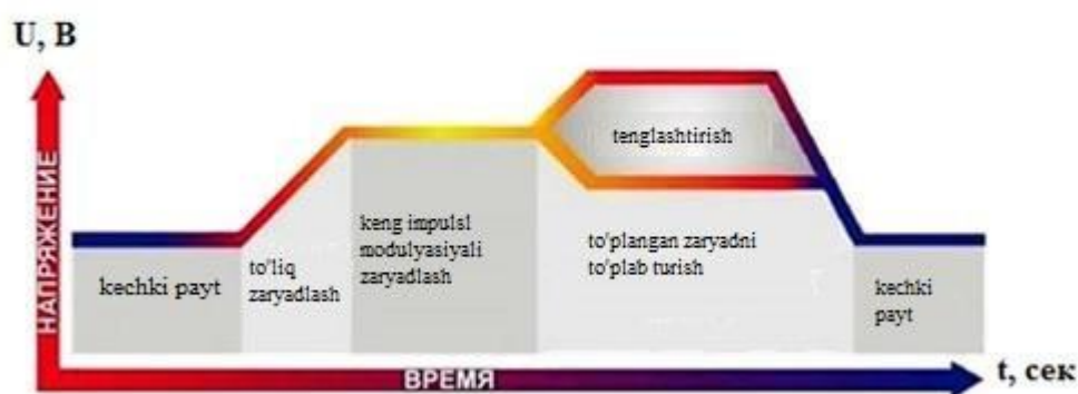
2.30-rasm. Quyosh panelidan akkumulyatorni zaryadlashdagi bosqichlar
