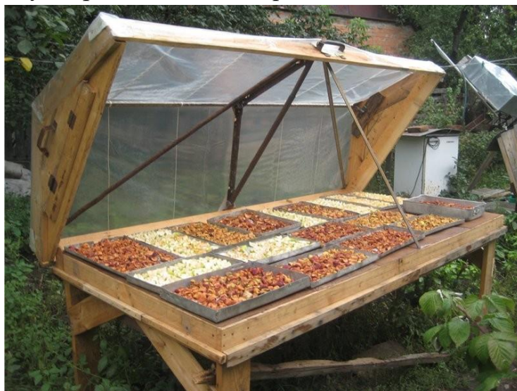
6.4.1-rasm. Polietilen qoplamaga ega bo‘lgan quyosh quritish qurilmasi.
