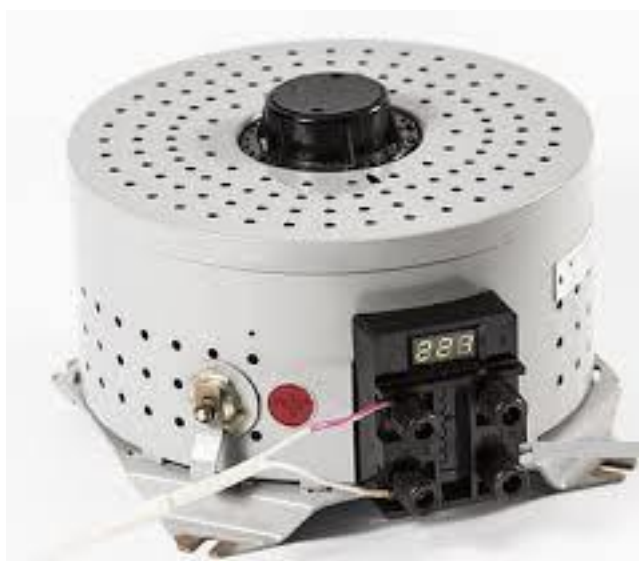
55-rasm. Laboratoriya avtotransformatorining umumiy ko‘rinishi.
