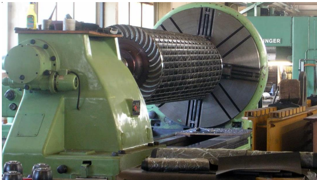
25-rasm. Banki gidroturbinasining umumiy ko‘rinishi.
