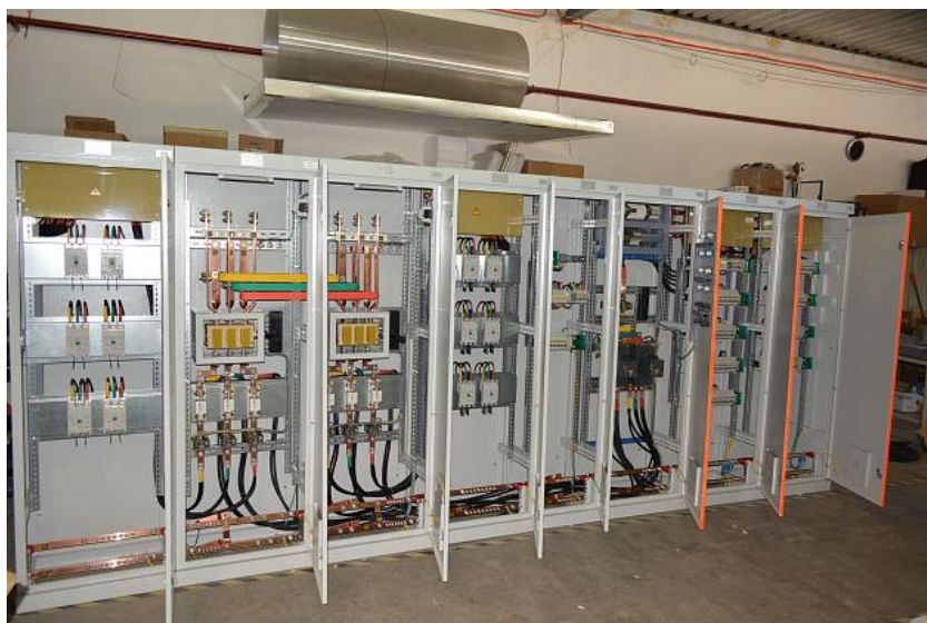
59-rasm. Quyi kuchlanishlarda qo'llaniladigan yopiq taqsimlash qurilmalari.
