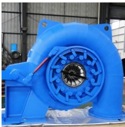
23-rasm. Fransis gidroturbinasining umumiy ko'rinishi..
