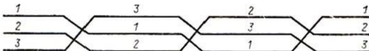
38-rasm. Bir zanjirli elektr uzatish liniyasi o'tkazgichlarini transpozitsiyalash sikli.
