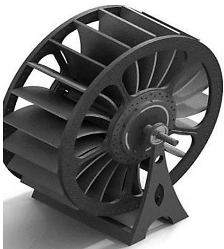
a) yuqori tezlikda aylanuvchi mikroGES suv charxpalagi modeli
