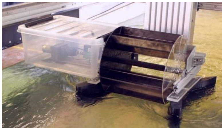
6.3-rasm. Olivier Cleynen, Emeel Kerikous, Stefan Hoerner tomonidan yaratilgan erkin tokga oʻrnatilgan mikrogidroelektr stansiya.
