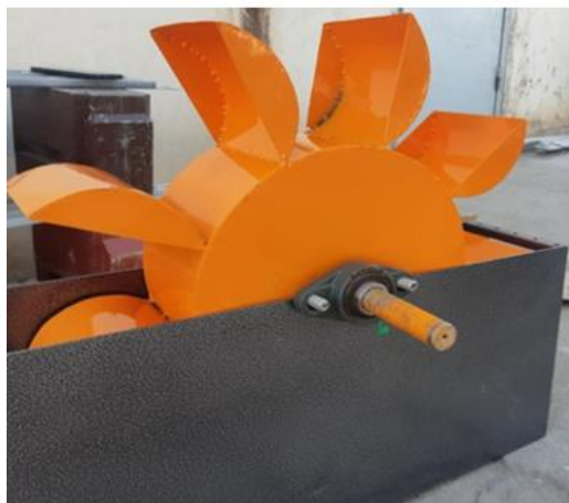
6.9-rasm. O.U. Zoxidov tomonidan ishlab chiqilgan faza rotorli asinxron generatorli mikroGES [85].
