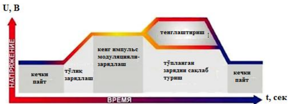
4.5-расм. Қуёш панелидан аккумуляторни зарядлашдаги босқичлар
