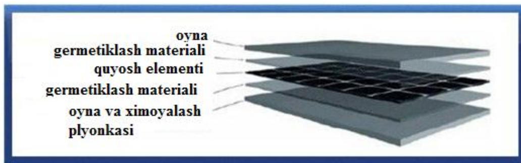
3.14-расм. Қуёш модулининг таркиби
