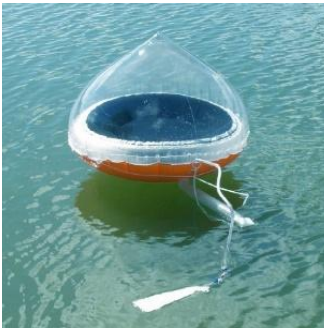
2.8-расм. Қуёш энергияси ёрдамида сувни чучуклантирувчи қурилма
